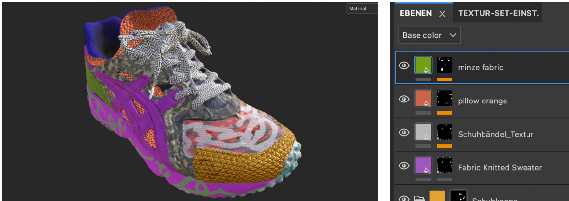
Abb. 1 3D-Scan eines Schuhs: Design mit verschiedenen Materialien und entsprechend vielen Füllebenen
